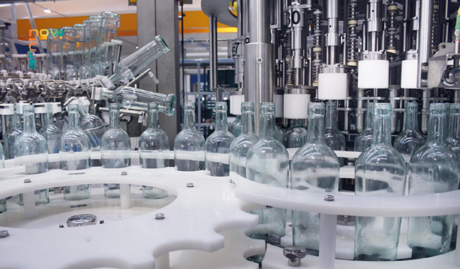
Les développements les plus récents en matière de recherche et d'innovation ont conduit à la réalisation de modèles de remplisseuses équipées d'un châssis divisé «walk-in», qui permet à l'opérateur d'accéder facilement aux sections de remplissage et de bouchage.
