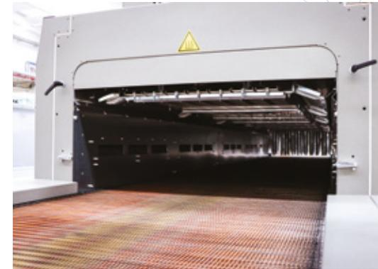
**T**utte le fardellatrici e macchine combinate SMI sono disponibili nella versione con tunnel di termoretrazione alimentato ad energia elettrica (soluzione standard) oppure con tunnel alimentato a gas metano; quest'ultima versione è una soluzione tecnologica innovativa e sostenibile, poiché i vantaggi in termini economici (in molti Paesi del mondo) e ambientali del metano rispetto al petrolio sono innumerevoli.
