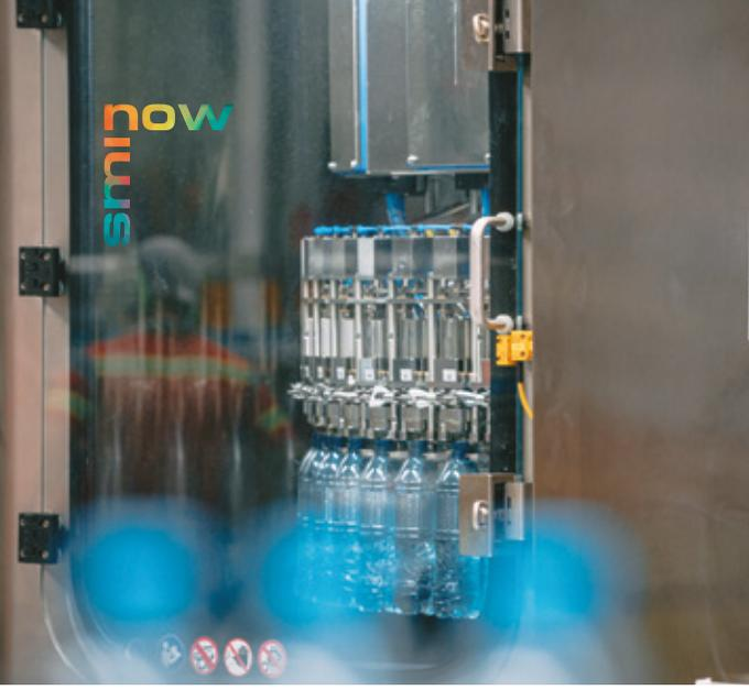
➤ **MONOBLOC DE REMPLISSAGE ET BOUCHAGE HEVF/ECO 60/94-12/94 EN CONFIGURATION ECOBLOC® AVEC L'ÉTIREUSE-SOUFFLEUSE**
