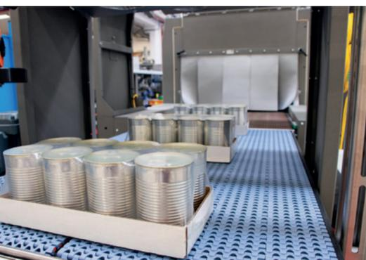
• **AFCW** (Angular Film Carton Wrapper) **ERGON**, modello "combi" che raggruppa le funzioni di una fallatrice ASW e di una cartonatrice ACW.
