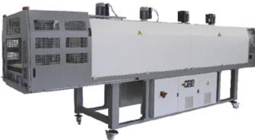
automatiquement à compenser la différence de vitesse de la fardeleuse / four moyennant le réglage des tapis de passage entre les deux modules ; ce qui permet d'obtenir des paquets thermorétractés de haute qualité, indépendamment du format. Le tunnel pour boîtes est disponible en cas d'opérations de conditionnement en simple, double et triple piste.
