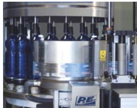
» **réduction jusqu'à 90% de la consommation d'eau** pour le nettoyage de l'installation, grâce au fait que la technologie "baseless" appliquée à la remplisseuse, permet de "libérer" l'embase de la machine d'organes et parties mécaniques en mouvement, où habituellement la saleté et les déchets du processus de production s'accumulent;
