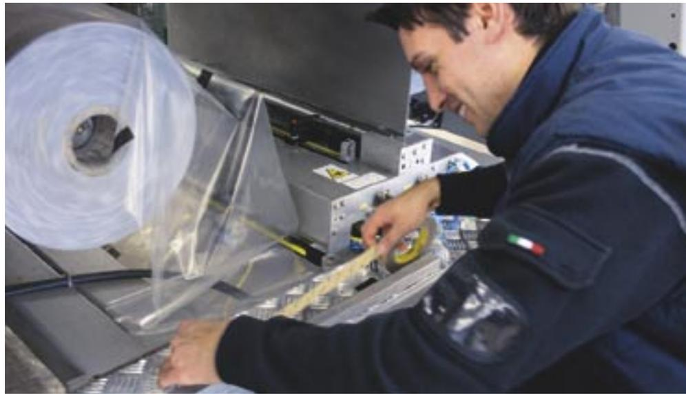
des deux bobines de film thermorétractable installées au-dessous du plan de travail de la machine. L'opération de
